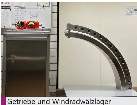
Getriebe und Windradwälzlager
