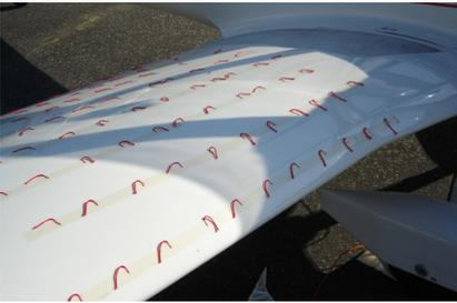
kann ich erst noch beim Durchchecken der Flugzeuge am Boden zuschauen. Alle Ruderfunktionen, die Luftbremse und der Motor werden geprüft. Auf der rechten Tragfläche kann man auch erkennen, warum das Fädchenfliegen Fädchenfliegen heißt: Sowohl an der Flügelwurzel als auch am äußeren Ende sind Stofffädchen aufgeklebt worden. An ihnen kann man später im Flug erkennen,
